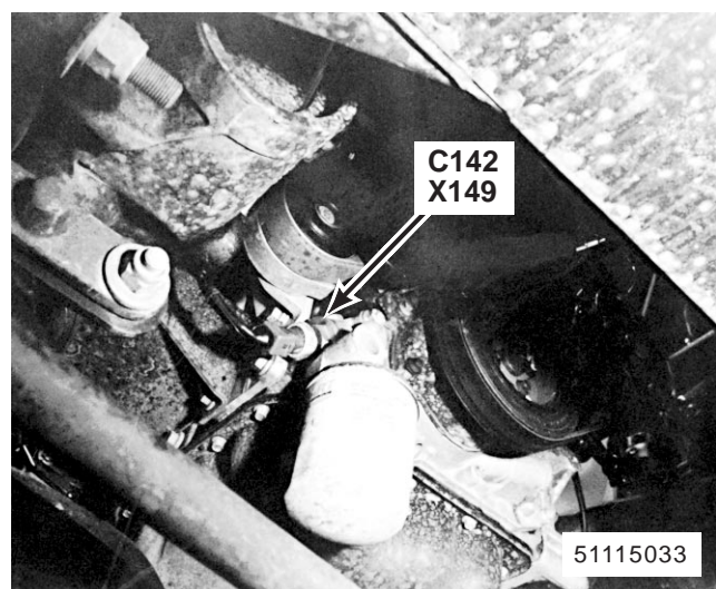
35. lado inferior derecho del motor MFI-T16 X149 Interruptor de presión de aceite C142 (2-N)
